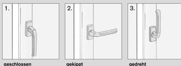
**Zweiflügelige Terrassentüren** werden durch Drehen des Griffs um 180° und gleichzeitiges Öffnen des Gleitflügels geöffnet. Lösen Sie anschließend den Paskvilkolben (9) in der Mitte des seitlichen Rahmens, um die Tür zu öffnen.
