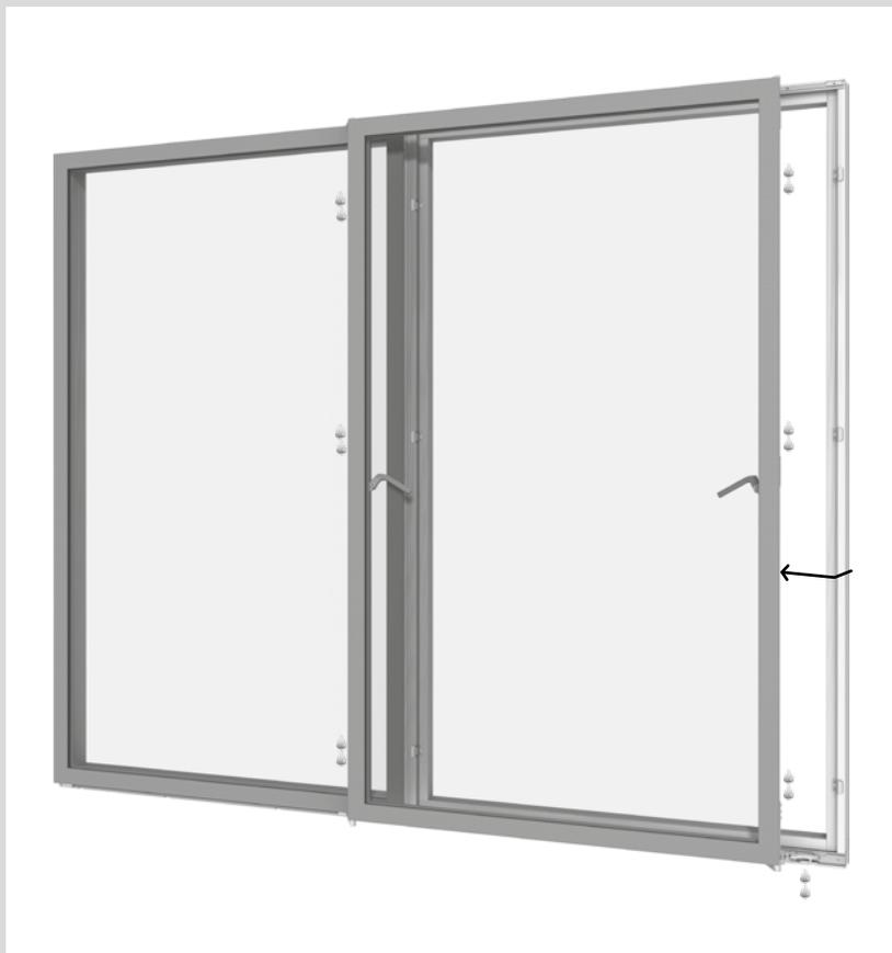
**Zum Öffnen der Schiebetür** drehen Sie die Griffe an den Seiten des Fensters in horizontale Position, drücken das Fenster circa 10cm nach außen und schieben es anschließend zur Seite. Zum Schließen gehen Sie umgekehrt vor und bringen anschließend die Griffe wieder in ihre vertikale Ausgangsposition.
