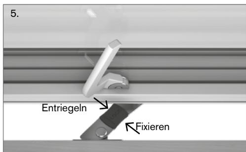
**Feststellen der Lüftungsposition.** Den Öffnungsbegrenzer fixieren Sie, indem Sie die rote Oberfläche drücken, bis ein Klicken zu hören ist. Fixieren Sie den Begrenzer nicht, wenn Sie das Fenster wenden möchten, um es zu reinigen.
