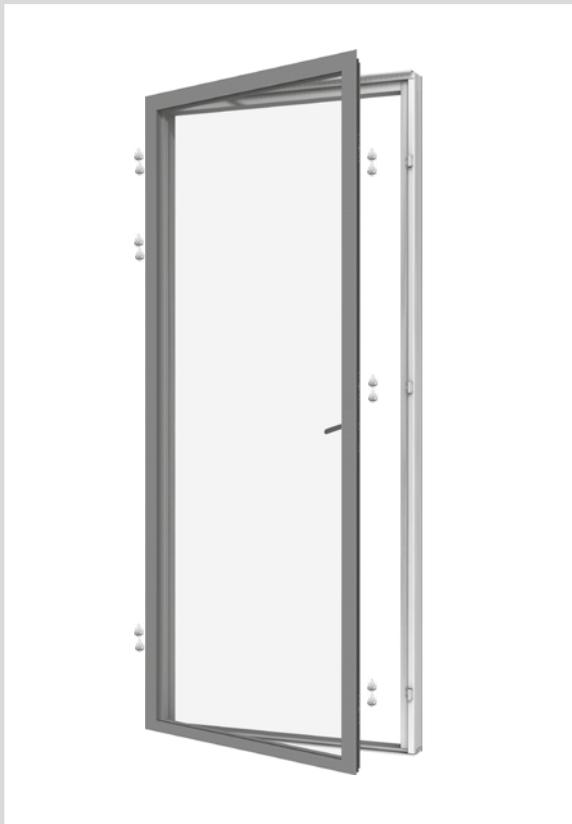
**Zum Öffnen der Terrassentür** drehen Sie den Griff in horizontale Position und drücken den Türflügel nach außen. Die Tür öffnet sich zu maximal 90° und ist mit einer Friktionsbremse ausgestattet, um die Tür in der gewünschten Position zu halten. Optional können Türen mit Beschlägen ausgestattet werden, die eine Öffnung bis zu 180° erlauben, wobei dann keine Friktionsbremse verbaut werden kann.
