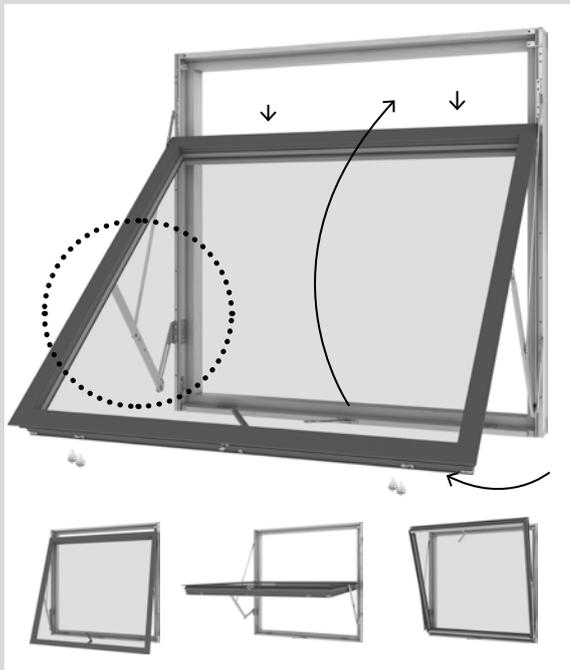
Das Fenster lässt sich öffnen, indem der Griff in vertikale Position gebracht und der Flügel nach außen gedrückt wird. Ab 5 bis 10cm blockiert die Öffnungsbegrenzung und verhindert ein weiteres Öffnen. Bitte überprüfen Sie, ob Ihr Fenster mit geraden Beschlägen oder mit Gelenkbeschlägen ausgestattet ist. ☼
