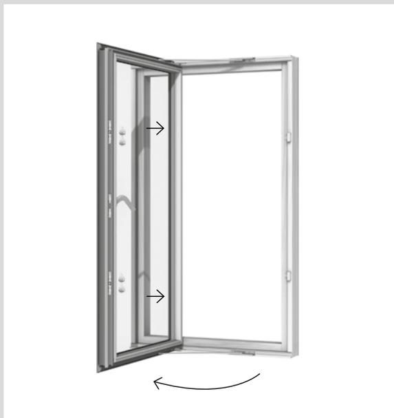
Das Fenster lässt sich öffnen, indem der Griff in horizontale Position gebracht und der Flügel nach außen gedrückt wird.
