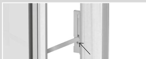
► **Der abschließbare Öffnungsbegrenzer** begrenzt die Öffnung des Fensters auf 1,5 bis 10 cm. Den Begrenzer lösen Sie mithilfe eines 5 mm Innensechskantschlüssels. Achten Sie darauf, dass die Kindersicherung nach dem Lösen manuell wieder fixiert werden muss.
