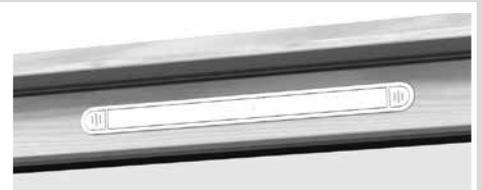
**Das Lüftungsventil** ist im Rahmen verbaut und ermöglicht es, den Raum ohne Öffnen des Fensters zu lüften. Das Ventil öffnen Sie, indem Sie mit der Hand auf die grauen Streifen an einem oder an beiden Enden des Ventils drücken.
