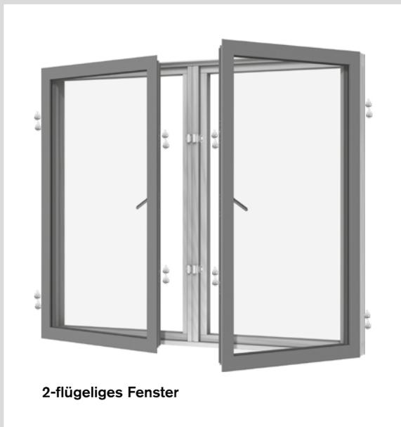
Das Fenster lässt sich öffnen, indem der Griff in horizontale Position gebracht und der Flügel nach außen gedrückt wird. Das Fenster lässt sich bis maximal 90° öffnen und ist mit einer Friktionsbremse ausgestattet, die es erlaubt, den Flügel in jeder gewünschten Position zu halten.
